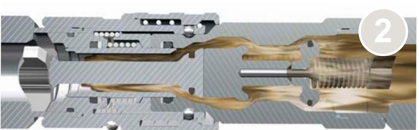
1. Lorsque la valve de décompression s'ouvre, la pression est absorbée. Lorsque la pression est équilibrée, l'embout peut être connecté facilement.
