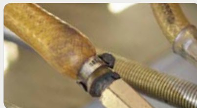
ホースクランプを使用したカップリングによるエア漏れの実例
